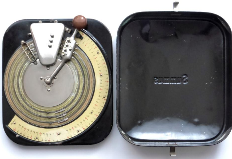
Abb. 1: Die Addiermaschine Summus mit zugehörigem Deckel
